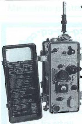
⇐ 1012141 **Ricetrasmittitore R105M**. Ottimo apparato in dotazione agli eserciti russi, bulgari, DDR. Versione mista valvole-transistors. Alimentato con due batterie da 2,4 VDC, opera nella gamma FM da 36 a 46,1 MHz. Contenuto in una cassa di legno (cm 59x32x38, peso Kg 34) insieme a tutti gli accessori. (per il 95% mai usati). Oltre al manuale in cirillo, ha schema di alimentazione e breve descrizione in tedesco. In ottimo stato, molti non sono mai stati usati.
